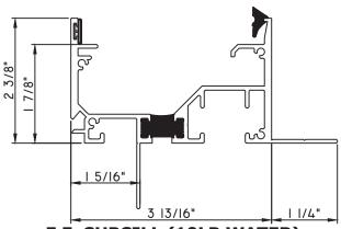
F.F. SUBSILL (10LB WATER) M17538 - SUBSILL BPN-9159 - W.S. 4874-02-00-19 - WEDGE GASKET ADDITIONAL PARTS FOR SQUARE CUT INSTALL: QWP-10LBENDDAM - END DAM (QTY. 2) BRBTT46 - POP RIVET (QTY. 8)
